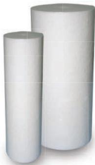
Los cartuchos Pura Plex de polipropileno son fabricados 100% de fibra de polipropileno puro. Son una solución económica para la pre-filtración en muchas aplicaciones. Son fabricados a través de un proceso especial que térmicamente adhiere las microfibras de polipropileno, con menor densidad en la parte exterior y progresivamente mayor densidad hacia la parte interior. Ampliamente son usados como pre-filtración en sistemas ósmosis inversa y post-filtración para filtros de carbón activado.
